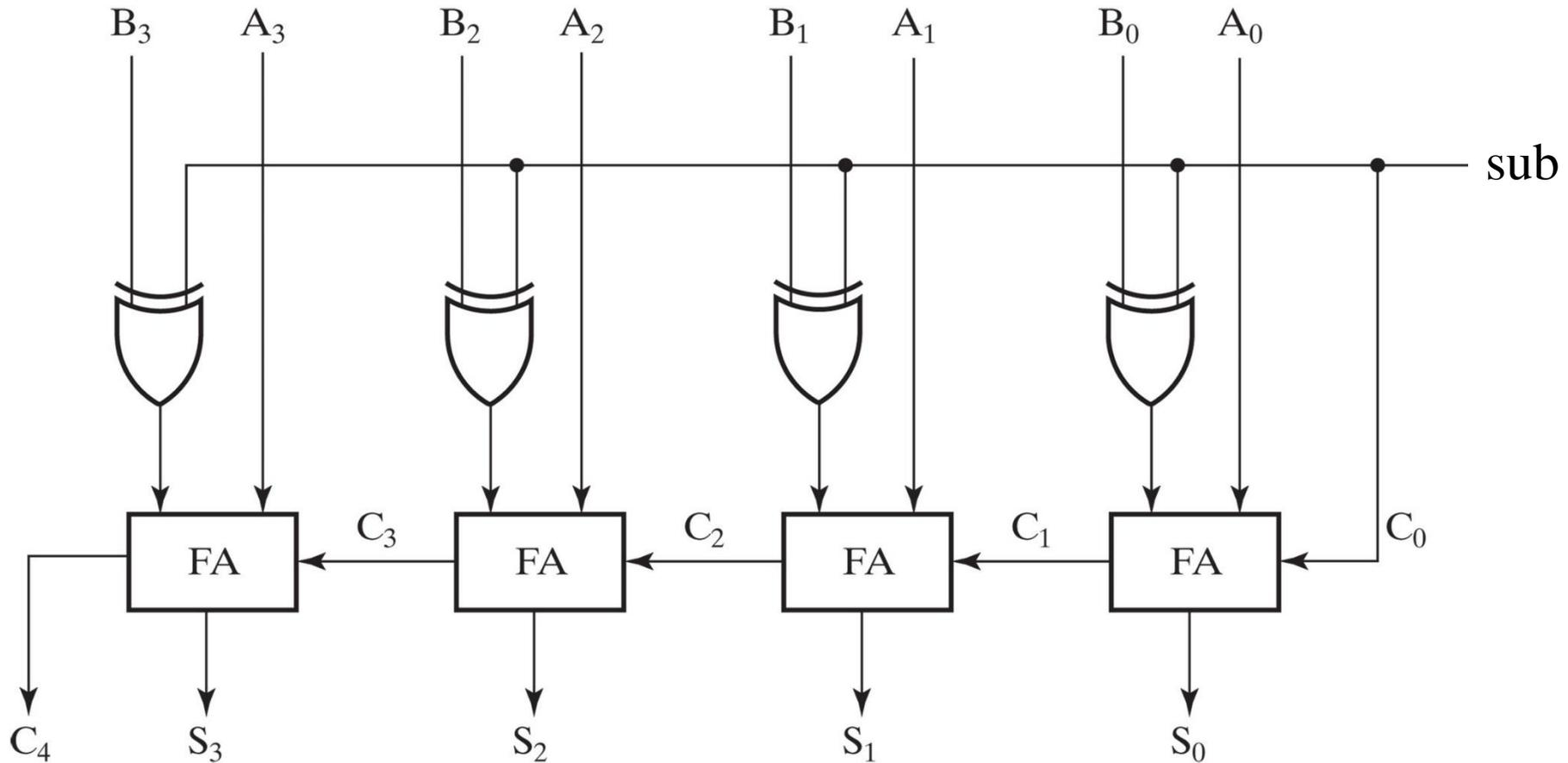
Input:  $A_i$ ,  $B_i$ ,  $sub$  (se  $sub = 0$ : esegue la somma, se  $sub = 1$  esegue la sottrazione)
