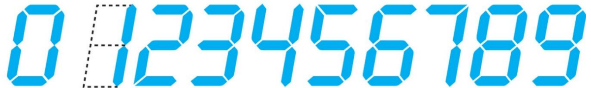
Rappresentazione delle 9 cifre BCD sul display
