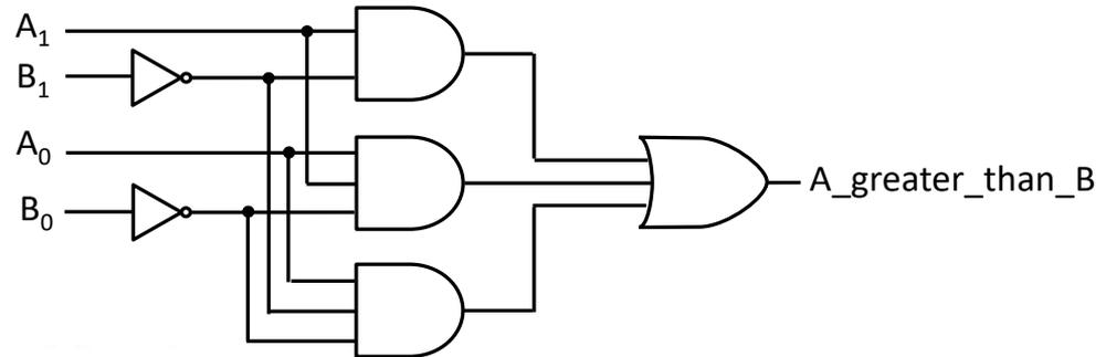
Dichiarazione dei segnali interni, cioè i nodi interni del circuito (uscite dei 2 inverter, uscite delle 3 porte AND)
