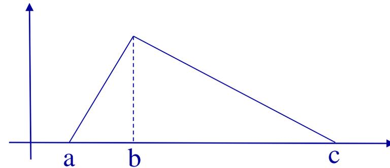
$$x = a + (c-a) * \text{SE}\{u < d; \text{RADQ}(ud); 1 - \text{RADQ}[(1-d)(1-u)]\}$$
