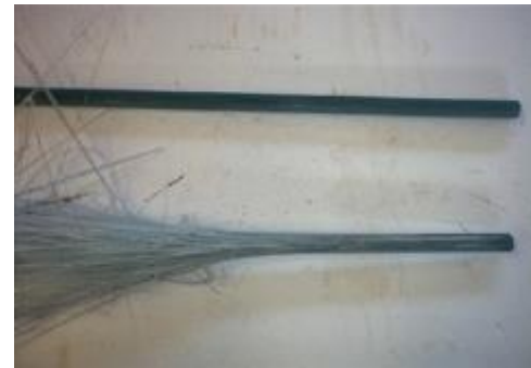
Rottura di barre in GFRP (fibre di vetro)
