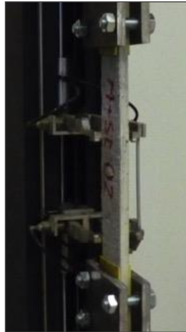
Setup con gomma alle estremità
