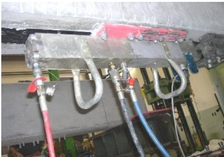
Pretensionamento con martinetto idraulico facente contrasto con la stessa trave.
