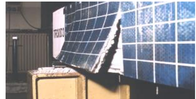
1 e 3 strati di CFRP con fibre trasversali all'asse della trave
