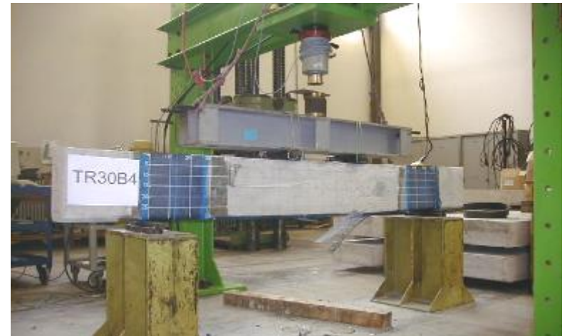
Rottura del rinforzo
