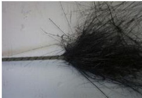
Rottura di barre in CFRP (fibre di carbonio)
