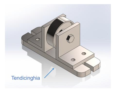
Mediante le viti (4) si fissano sulla piastra i due supporti (3).
