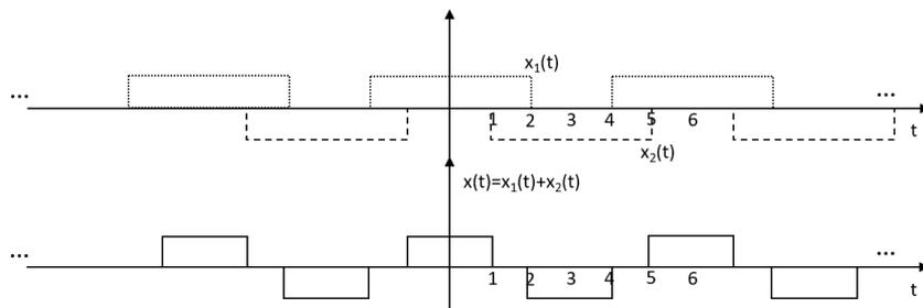
Figure 1: Il segnale  $x(t)$  è la somma dei segnali  $x_1(t)$  e  $x_2(t)$  rappresentati nel pannello superiore;  $x(t)$  è rappresentato nel pannello inferiore
