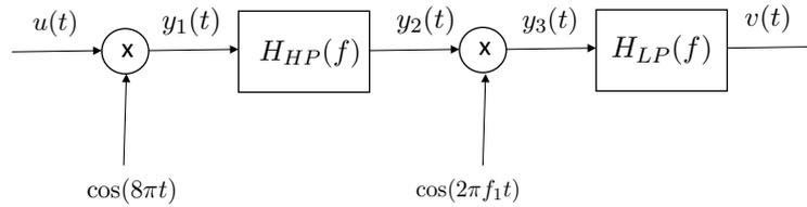
con ingresso  $u(t) = \text{sinc}^2(t)$  e dove il filtro passa-alto  $H_{HP}(f)$  ed il filtro pass-basso  $H_{LP}(f)$  hanno risposta in frequenza
