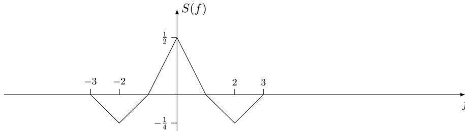
2. La trasformata di Fourier di  $x(nT)$  risulta  $X(f) = \operatorname{rep}_4 S(f)$  che coincide con l'onda triangolare
