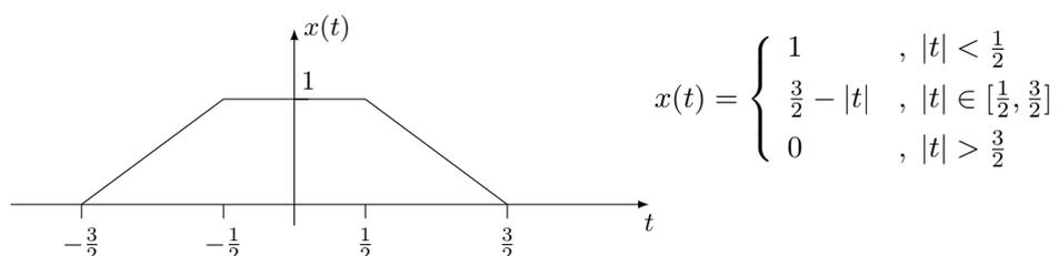
2. Per calcolare i coefficienti di Fourier del segnale  $x(t)$  basta notare che questo si ottiene per ripetizione periodica con periodo  $T_p = 4$  del segnale  $v(t)$ , e pertanto vale la relazione  $X(kF) = V(kF)$ , con  $F = 1/T_p = \frac{1}{4}$  e  $V(f)$  trasformata di Fourier di  $v(t)$ . Nel caso specifico si ha  $V(f) = 2 \text{sinc}(2f) \text{sinc}(f)$ , da cui si ottiene
