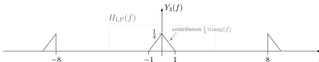
Dalla figura risulta inoltre evidente che l'applicazione del filtro passa-basso  $H_{LP}(f)$  garantisce la rimozione dei contributi a frequenza maggiore di 4, e una amplificazione di un fattore 4 di quelli a frequenze minori di 4 (in valore assoluto), e pertanto garantisce
