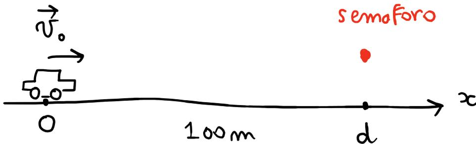
Velocità in funzione di  $x$  :  $v(x)^2 = v_0^2 + 2ax$
