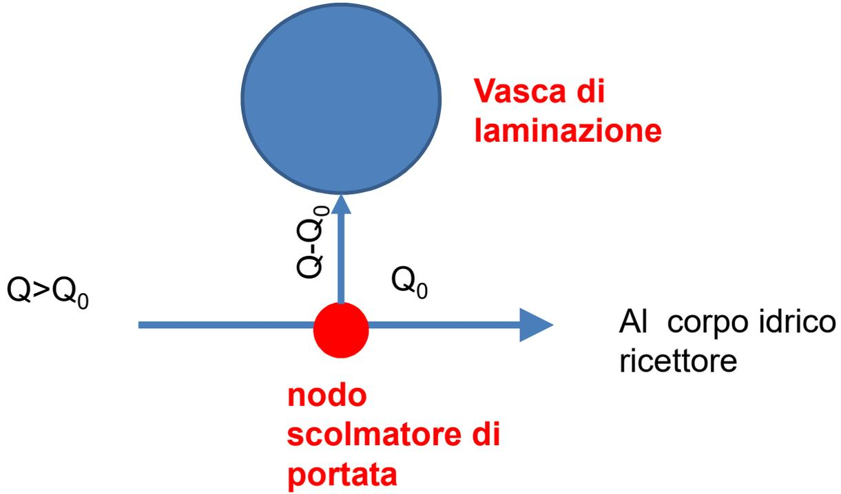
Calcolare il rischio che la vasca di laminazione risulti insufficiente ad invasare il volume di precipitazione, assumendo che:
