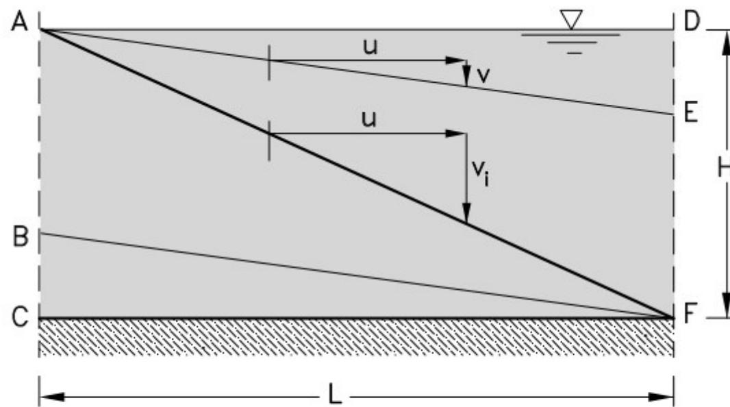
Fig. 8.85 traiettoria delle particelle in un dissipatore ideale.
