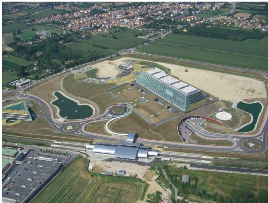
Prima dello scarico della rete di drenaggio a servizio dell'area commerciale, viene realizzata una vasca di laminazione fuori linea il cui volume è  $460 \text{ m}^3$ . La vasca lamina i deflussi provenienti dall'area commerciale, invasando il volume di scorrimento superficiale generato dalla precipitazione, quando la portata generata è più grande di quella che veniva scaricata prima della realizzazione del centro commerciale.
