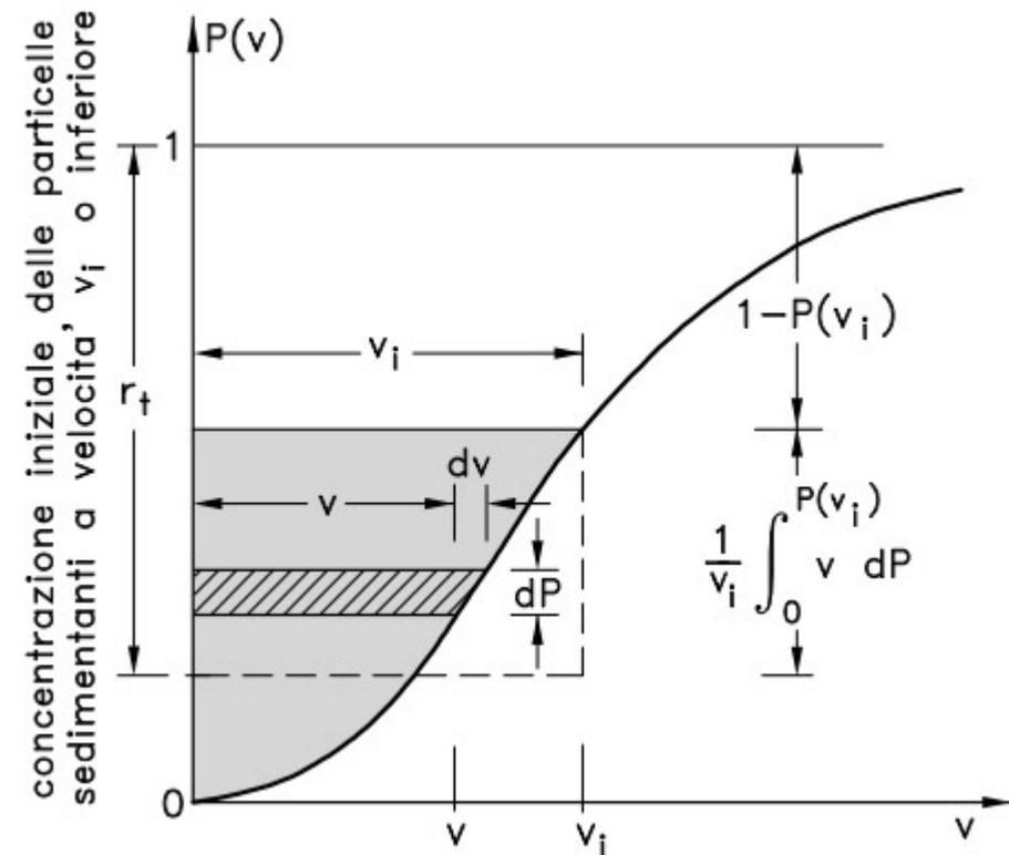
Si ha pertanto, considerando tutte le particelle caratterizzate da velocità di caduta  $0 < v < v_i$ , che la frazione totale  $r_t$  di particelle sedimentate è
