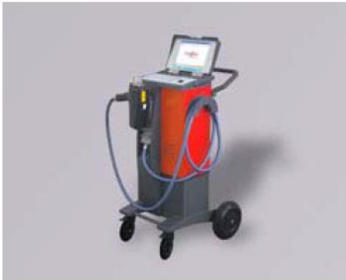
Spettrometro OES portatile
