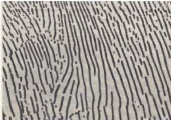
Acciaio eutettoidico. Struttura: perlite . Attacco: Nital (2000X)
