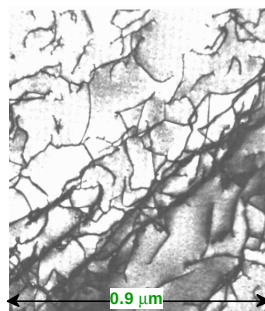
Lega di Ti dopo deformazione plastica a freddo
