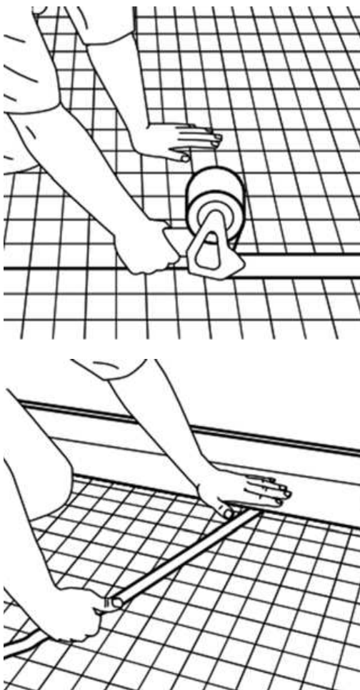
Figura I 19. Sigillatura dello strato isolante.
