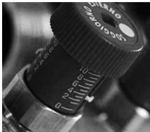
Figura 94. Valvola micrometrica di regolazione.
