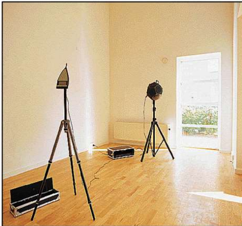
Figura 119: Posizionamento della sorgente sonora e del fonometro
