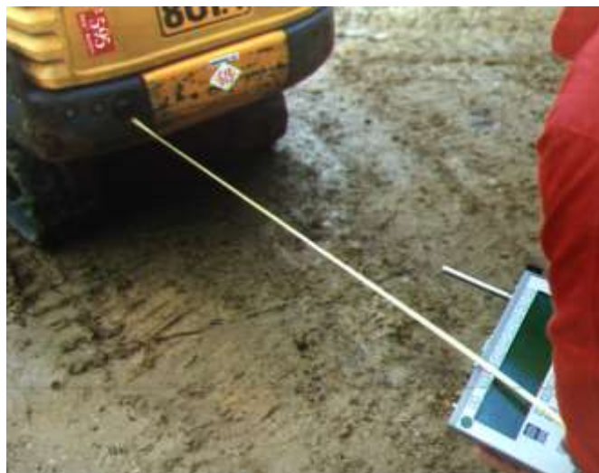
Figura 98: Modalità di misura dei livelli di potenza
