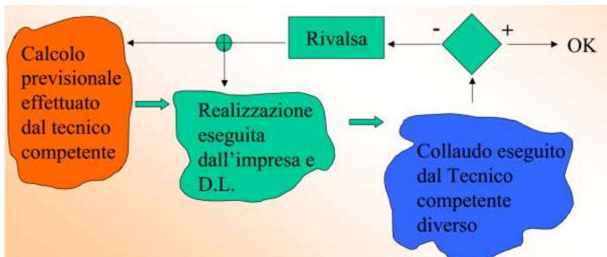
Figura 132: Percorso operativo del Tecnico Competente
