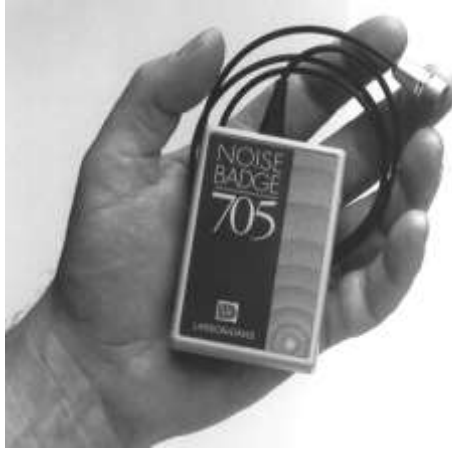
Figura 95: Dosimetro personale per il rumore
