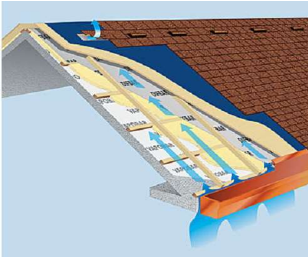
Figura 104: Copertura a falda ventilata
