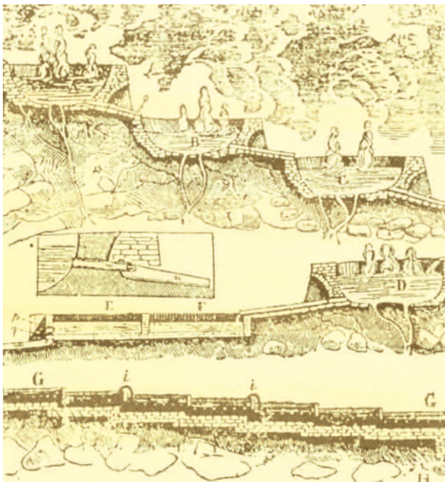
Fig. 18 - Larderello, Toscana. Lagoni naturali in cascata (A-B-C-D), con vasche di raccolta a valle (E-F) e vasche di evaporazione a gradinata in basso (G). Incisione del 1841. Larderello, Tuscany (an engraving of 1841). Natural "lagoni" in cascade (A-B-C-D) with downstream collecting tanks (E-F), and vaporization tanks with steps at the bottom (G).
