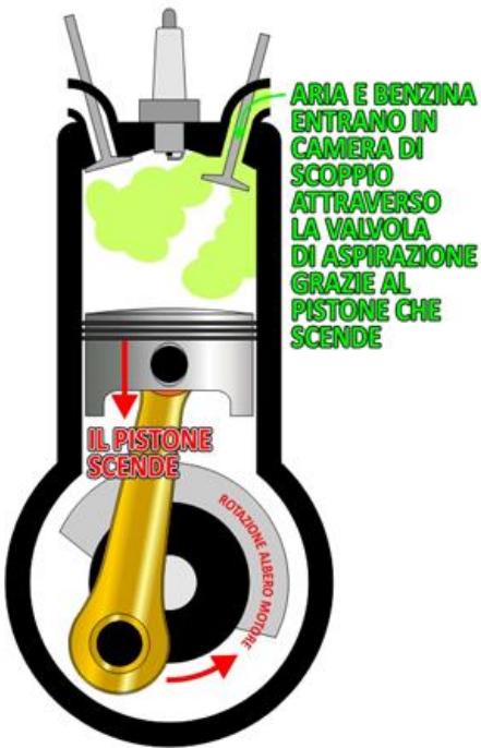
Fig. - Motore a 4 tempi ad accensione comandata (per scintilla elettrica)
