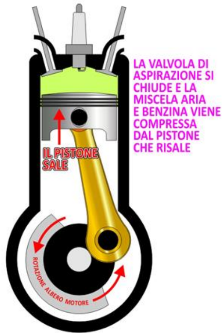
Fig. - Motore a 4 tempi ad accensione comandata (per scintilla elettrica)
