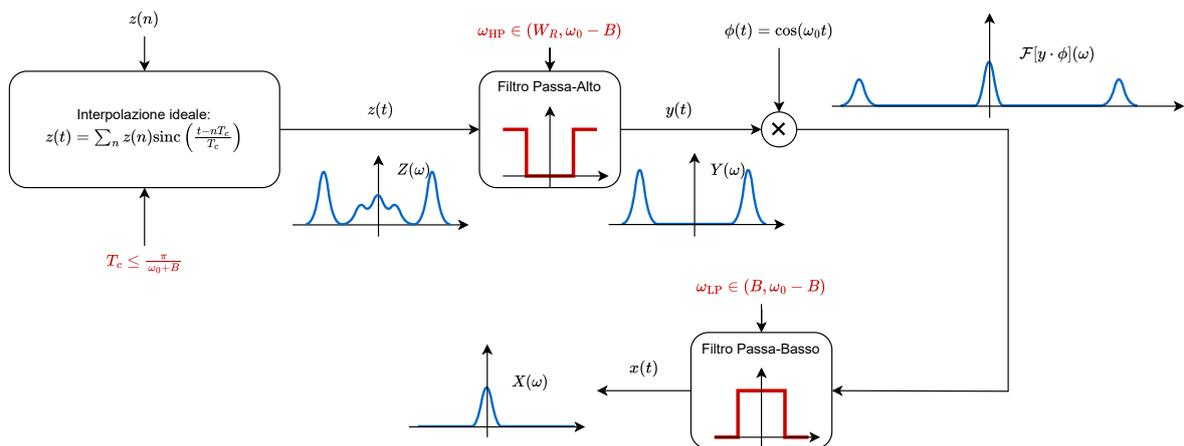
Figura 4: Schema del sistema che recupera  $x(t)$  dai campioni di  $z$ .
