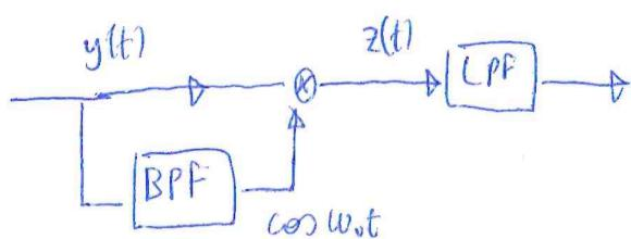
Il BPF può essere sostituito con un insieme non lineare: amplificatore limitato ad alto guadagno che rimuove la modulazione e lascia solo la portante.
