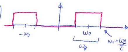
Filtro eliminatore ideale:  $H_{RB}(\omega) = 1 - \text{rect}\left(\frac{|w-w_0|}{w_B}\right)$
