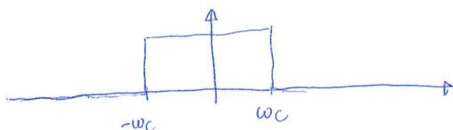
Dopo il filtraggio resteranno solo le componenti corrispondenti a  $|kw_0| < w_c$  cioè solo  $|k| < \frac{w_c}{w_0}$
