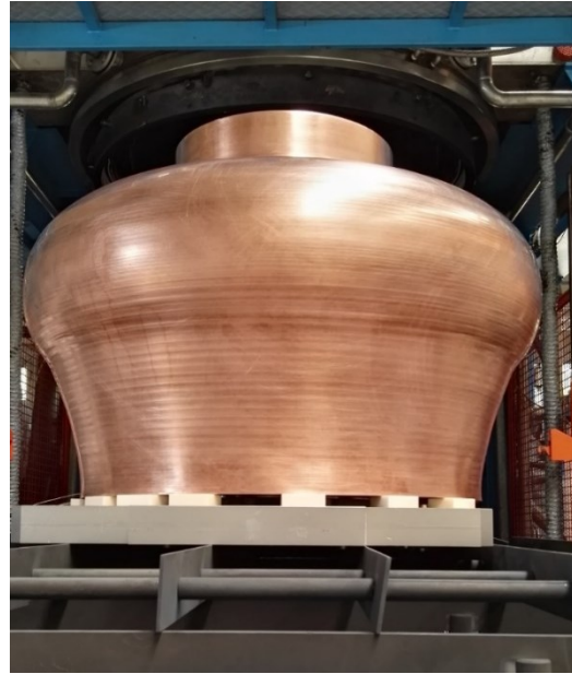
FIRST THERMAL ANNEALING
