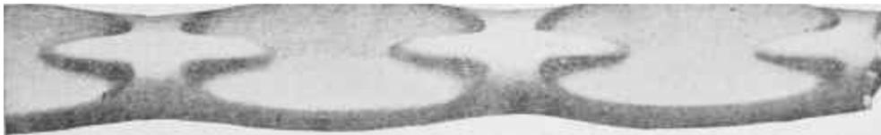
**Barra Thacher**, laminata a freddo e di sezione ovoidale. La sezione trasversale si mantiene praticamente costante sulla lunghezza e le variazioni di forma sono ottenute tramite raccordi curvilinei.
