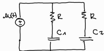
$$x_1(t) = v_1(t) : \text{tensione ai capi di } C_1$$
