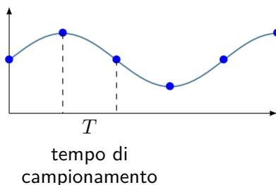
**DAC:** convertitore digitale-analogico (simile a un interpolatore) che trasforma un segnale digitale in un segnale analogico continuo
