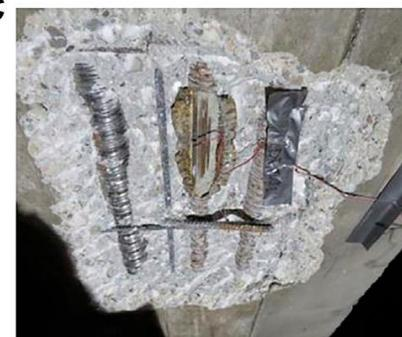
Prove innovative per la misura della tensione effettiva in ponti in c.a.p. a cavo post-tesi. Collaborazione con Veneto Strade.
