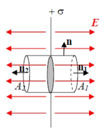
La carica è distribuita in maniera uniforme sul piano in modo che  $Q = +\sigma A$  ( $\sigma = densità superficiale di carica).$
