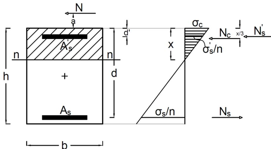
Figura 10 Sezione rettangolare armata soggetta presso-flessione (lo sforzo normale è applicato all'esterno della sezione)
