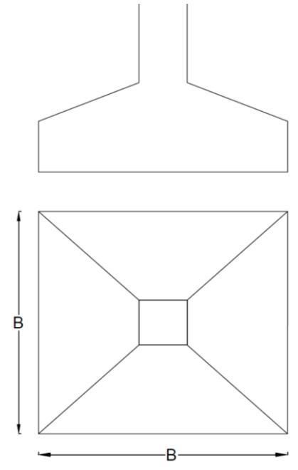
*Figura 6 Il plinto a pianta quadrata*
