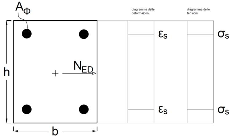
Figura 2 Sezione rettangolare in caso di sforzo normale di trazione
