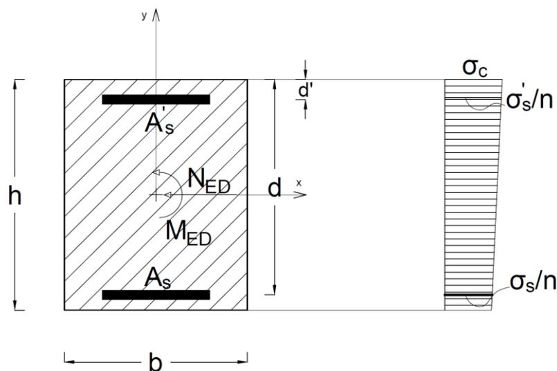
Figura 8 Sezione rettangolare armata soggetta presso-flessione (lo sforzo normale è applicato all'interno del nocciolo d'inerzia)
