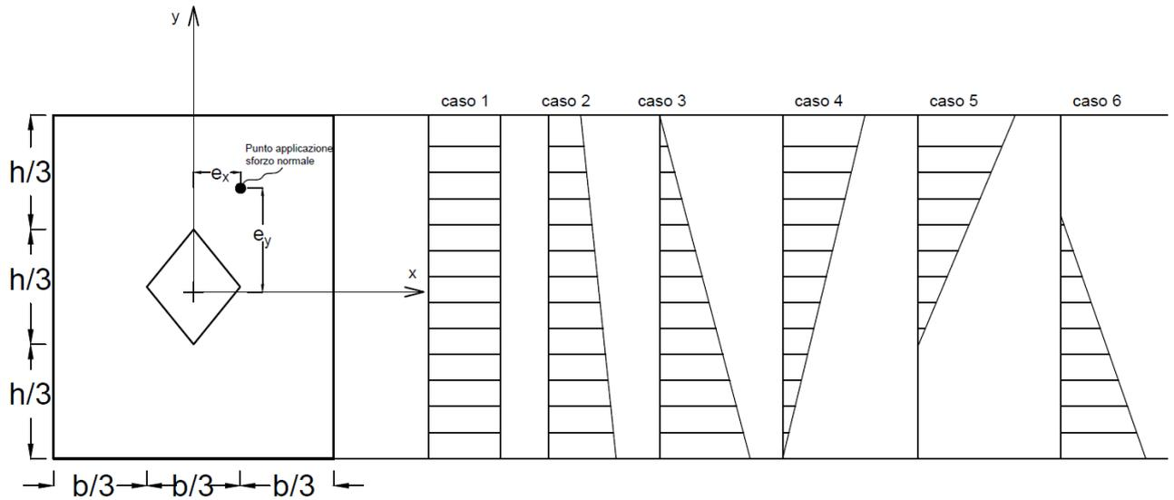
*Figura 5 Sezione rettangolare non armata soggetta presso-flessione*
