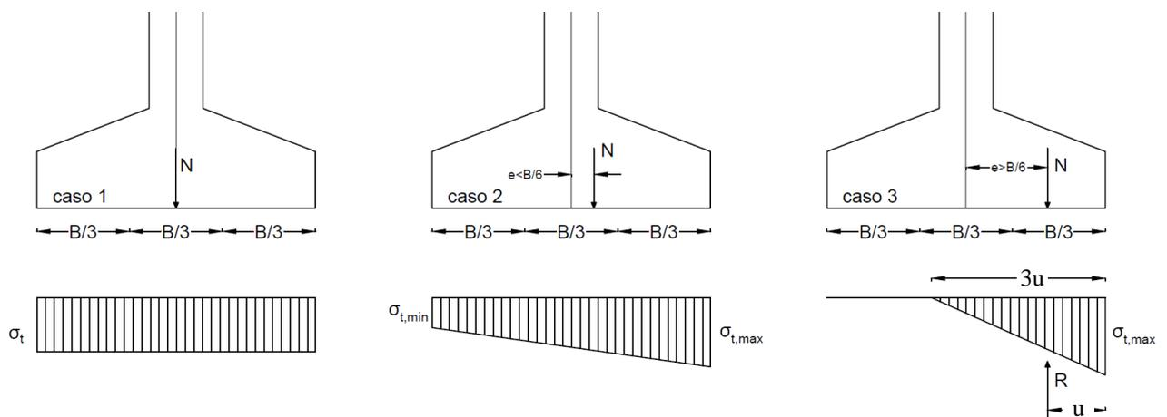
*Figura 7 Calcolo elastico della tensione sulla base del plinto (tre casi significativi)*
