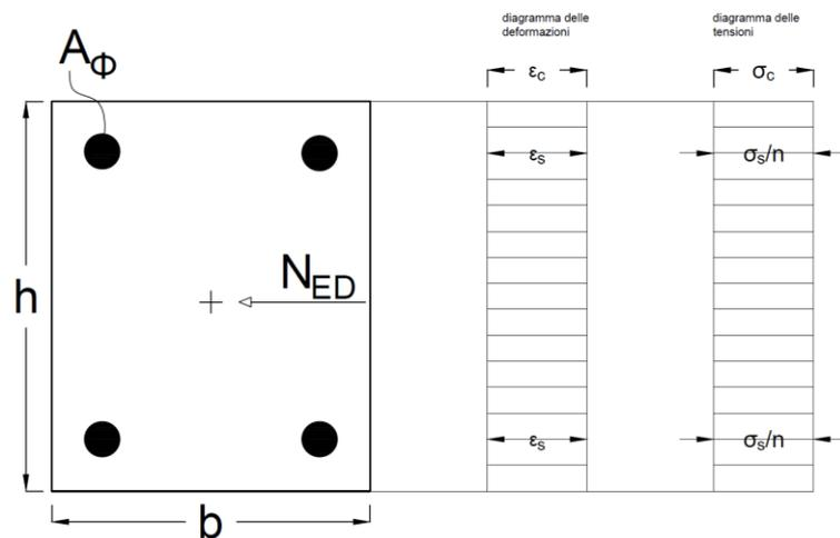
*Figura 1 Sezione rettangolare in caso di sforzo normale di compressione*
