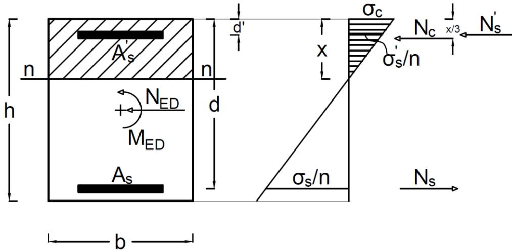
Figura 9 Sezione rettangolare armata soggetta presso-flessione (lo sforzo normale è applicato all'esterno del nocciolo d'inerzia)
