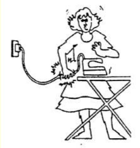
Contatto tra la persona e parti dell'impianto elettrico o di un utilizzatore che sono in tensione in condizioni di ordinario funzionamento.
