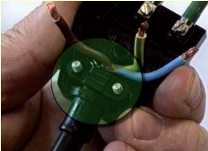
Spine e prese mobili devono essere dotate di un apposito dispositivo di **ancoraggio del cavo.**
