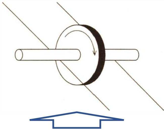
Esempio di sistema con raggio di inerzia molto maggiore del raggio di rotolamento
