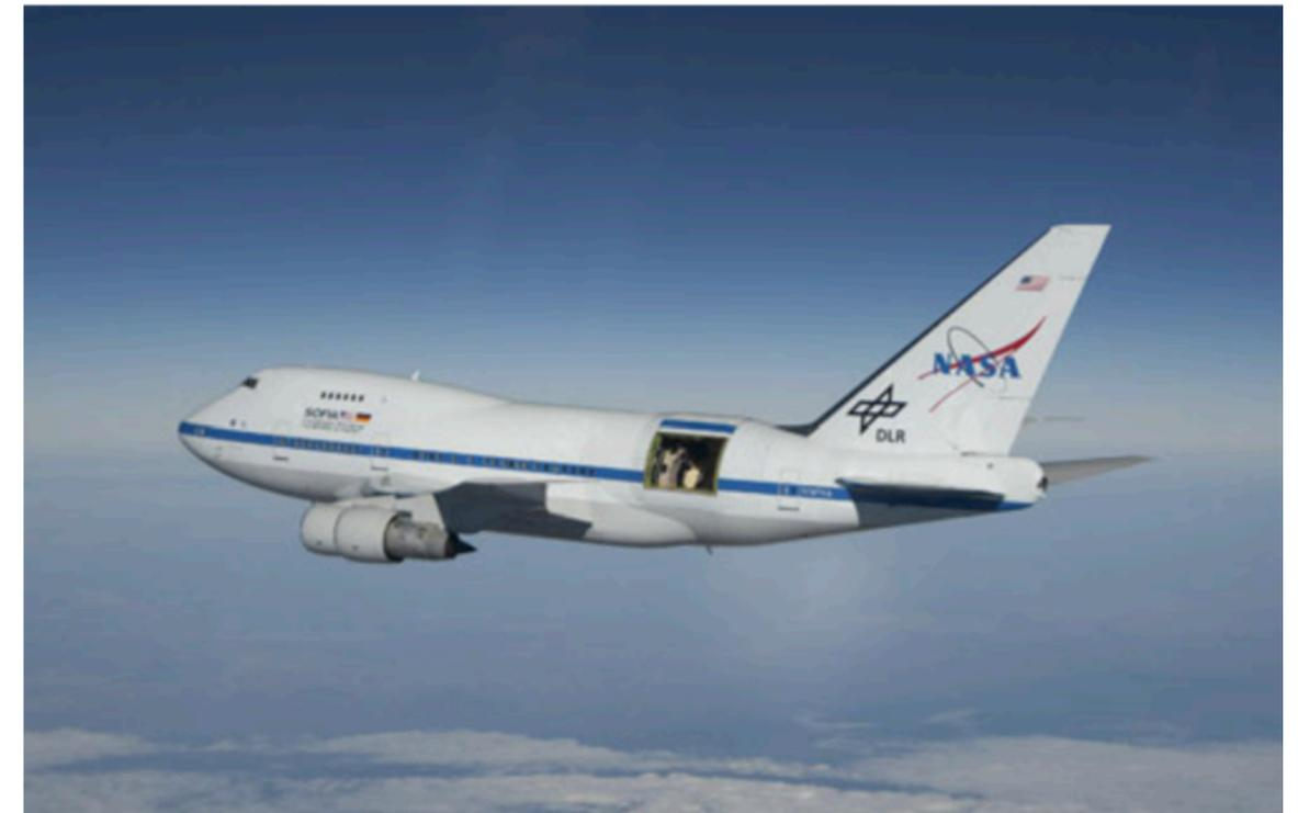
**SOFIA:** telescopio di  $2.5\text{m}$  su un Boeing 747 che vola a  $12\text{km}$  di altezza
