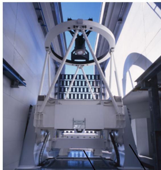
La luce viene convogliata dal telescopio sul piano focale, a monte del quale è posto un filtro che permette solo alla luce entro un intervallo di  $\lambda$  di passare.
