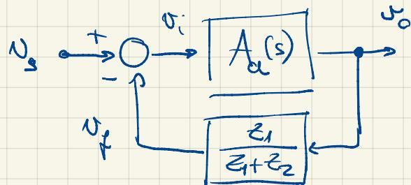
IT IS THE SAME BLOCK DIAGRAM FOUND BY DIRECT LOOP INSPECTION
