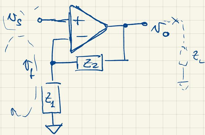
LET'S DRAW THE BLOCK DIAGRAM OF THIS CIRCUIT BASED ON FEEDBACK THEORY
