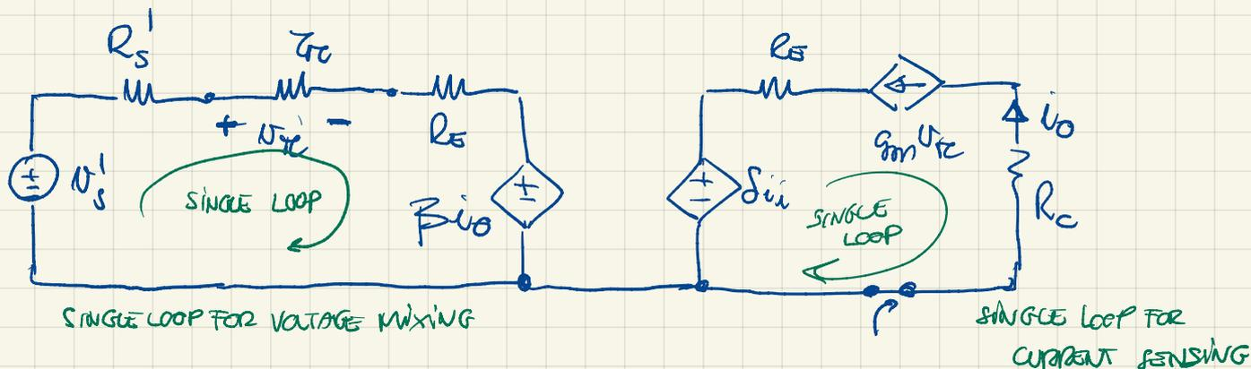
$$v_s' = v_s \cdot \frac{R_1 // R_2}{R_s + R_1 // R_2}$$
