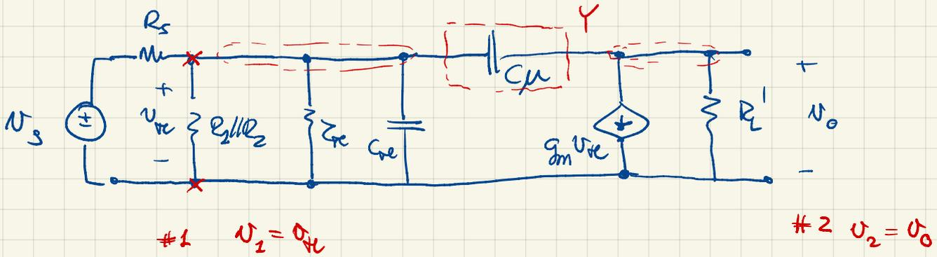
$$G \approx \left. \frac{v_o}{v_{be}} \right|_{MS} = -g_m R_L' \quad |G| \gg 1$$
