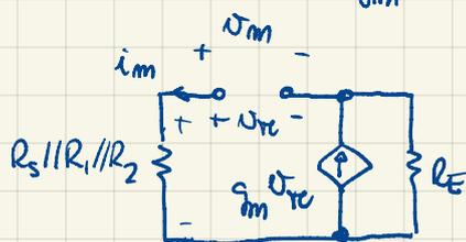
$$v_{re} = R_s // R_1 // R_2 i_{in} + R_E (i_{in} - g_m v_{re})$$
