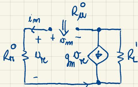
$$u_{re} = R_T^o i_{in} + R_L' (i_{in} + g_m R_T^o i_{in})$$
